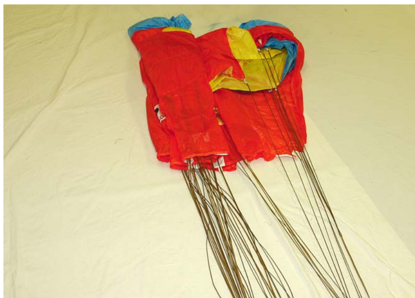
Рисунок 46 - Укладка задней части купола
