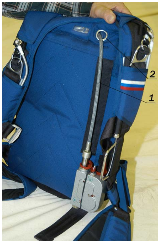
Рисунок 121 - Установка парашютного прибора на ранец
