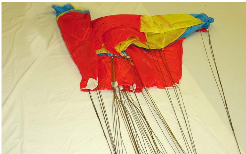
Рисунок 44 – Укладка задней части купола
