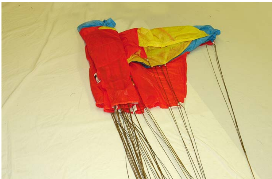
Рисунок 45 - Укладка задней части купола
