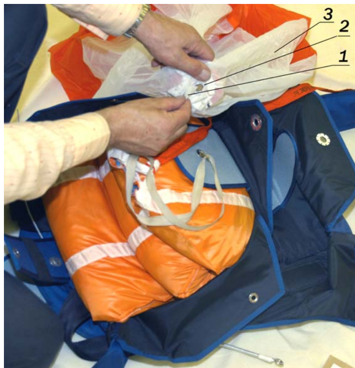
1 – затяжка; 2 – люверс; 3 – парашют вытяжной. Рисунок 63 - Укладка вытяжного парашюта
