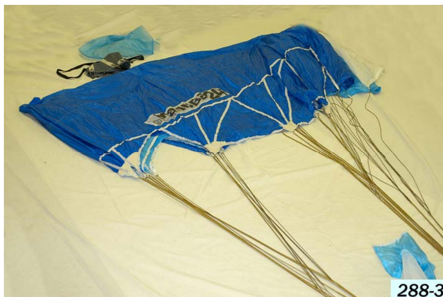
Рисунок 85 – Укладка передней части купола
