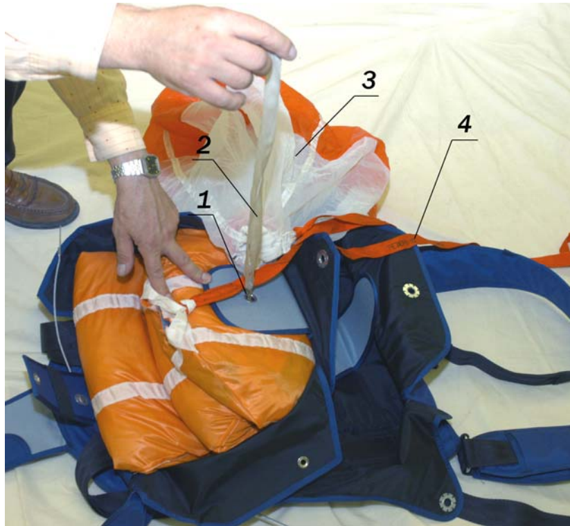
1 – петля; 2 – лента-затяжка; 3 – парашют вытяжной; 4 – звено парашютное. Рисунок 62 - Укладка вытяжного парашюта
