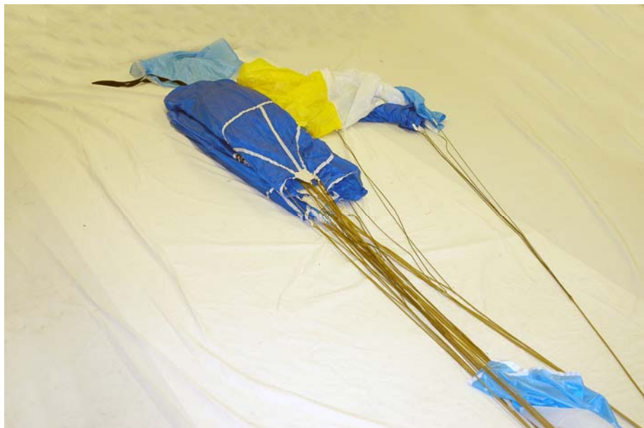
Рисунок 91 - Укладка задней части купола
