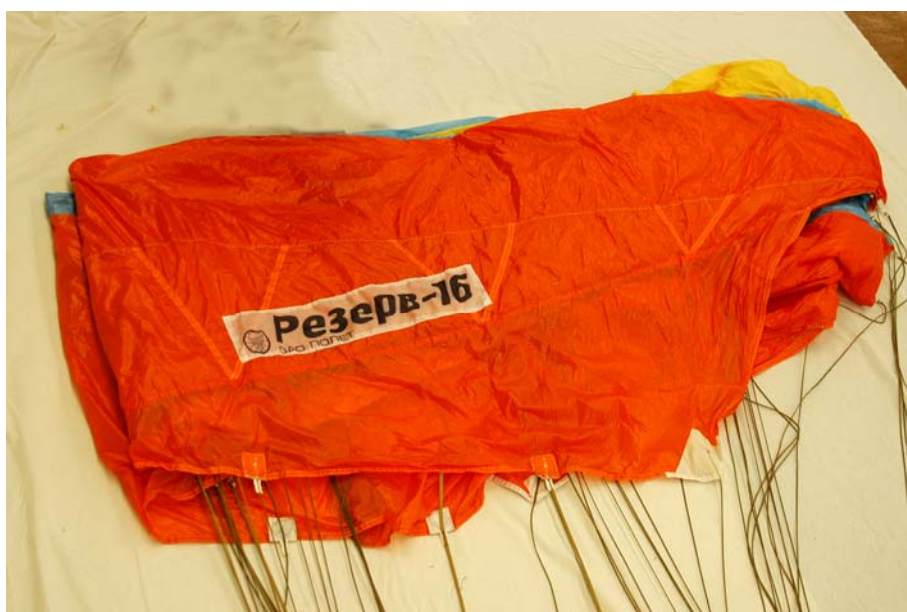
Рисунок 38 – Укладка передней части купола
