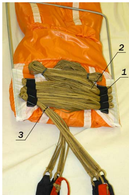
1 – лента распределителя сот; 2 – стропы; 3 – метка на стропках. Рисунок 55 – Укладка строп и контроль укладки
