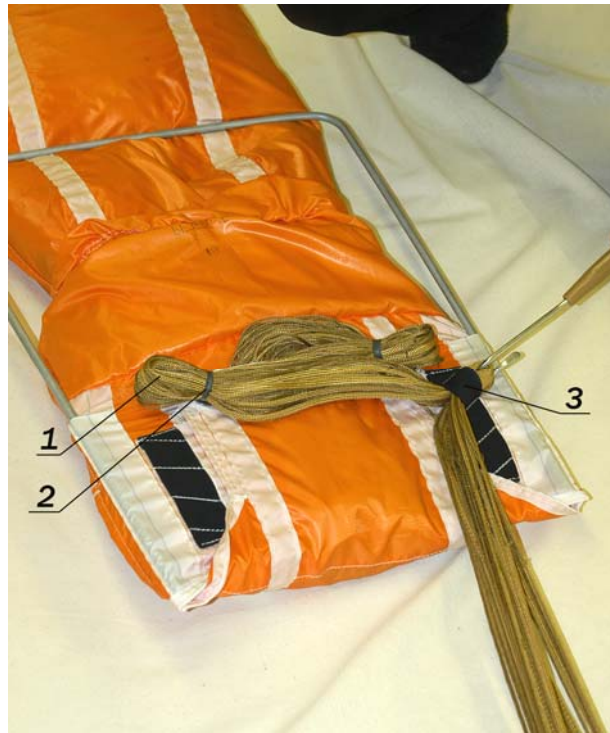
1 – пучок строп; 2 – петля (резиновая); 3 – верхняя сота распределителя строп Рисунок 54 – Укладка строп
