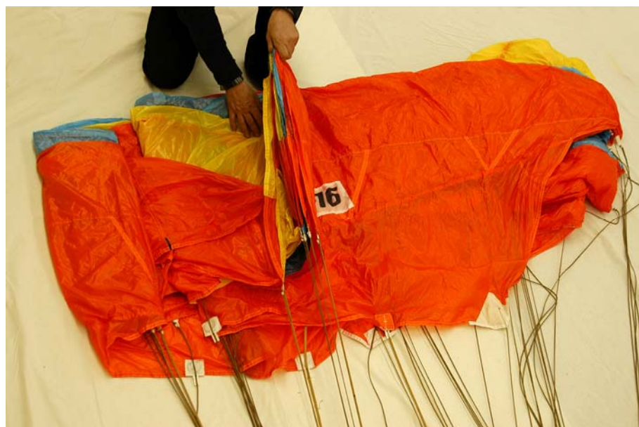
Рисунок 36 - Укладка передней части купола
