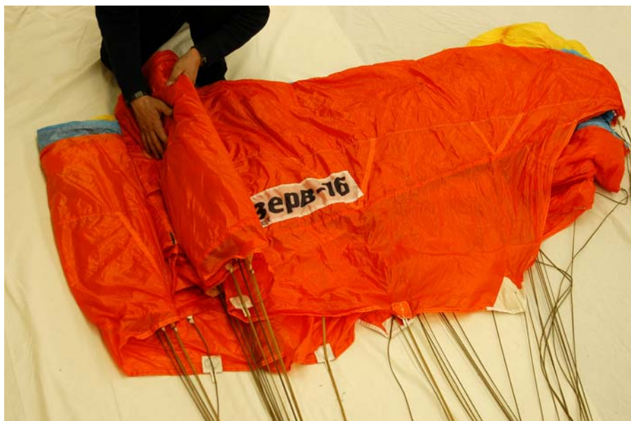
Рисунок 37 - Укладка передней части купола
