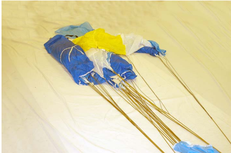
Рисунок 90 – Укладка задней части купола
