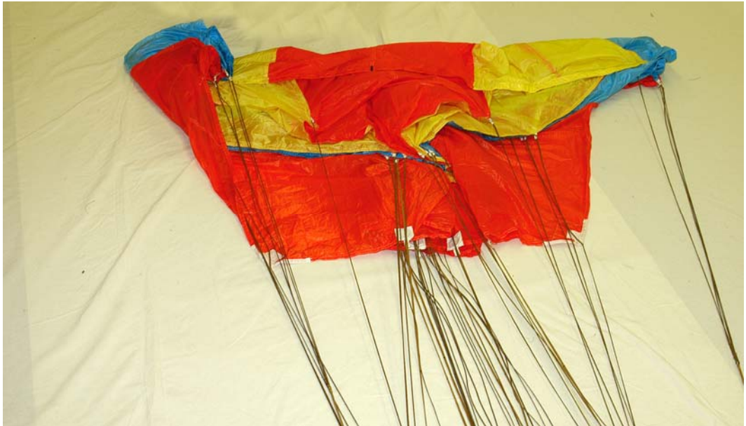
Рисунок 43 – Укладка задней части купола
