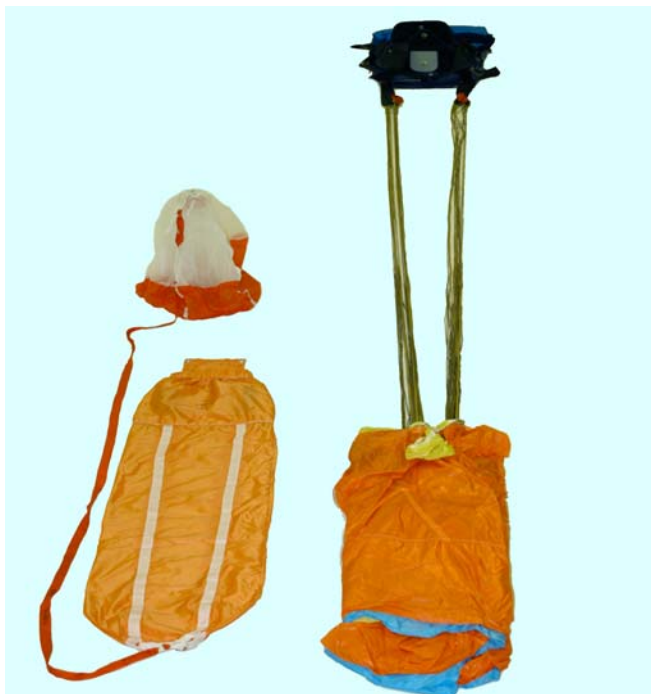
Рисунок 51 – Контроль укладки купола.
