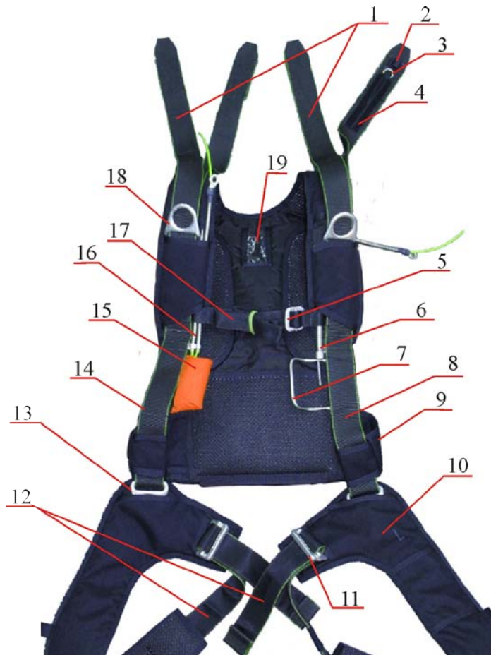
1-свободные концы запасного парашюта, 2- шлевка, 3- направляющее кольцо, 4- текстильная застежка, 5- регулировочная пряжка грудной перемычки, 6-шланг звена ручного раскрытия ПЗ, 7-звено ручного раскрытия ПЗ, 8-передняя лямка (левая), 9-поясной обхват, 10-предохранитель ножного обхвата, 11-регулирующая пряжка ножного обхвата 12-ножные обхваты, 13-D-образная пряжка, 14- передняя лямка(правая), 15-звено отсоединения КЗУ, 16-боудены КЗУ, 17-грудная перемычка, 18-пряжка КЗУ, 19-окно кармана контрольной панели страхующего прибора.
